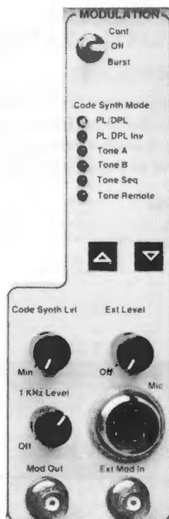
FIGURE 3-9. MODULATION SECTION
