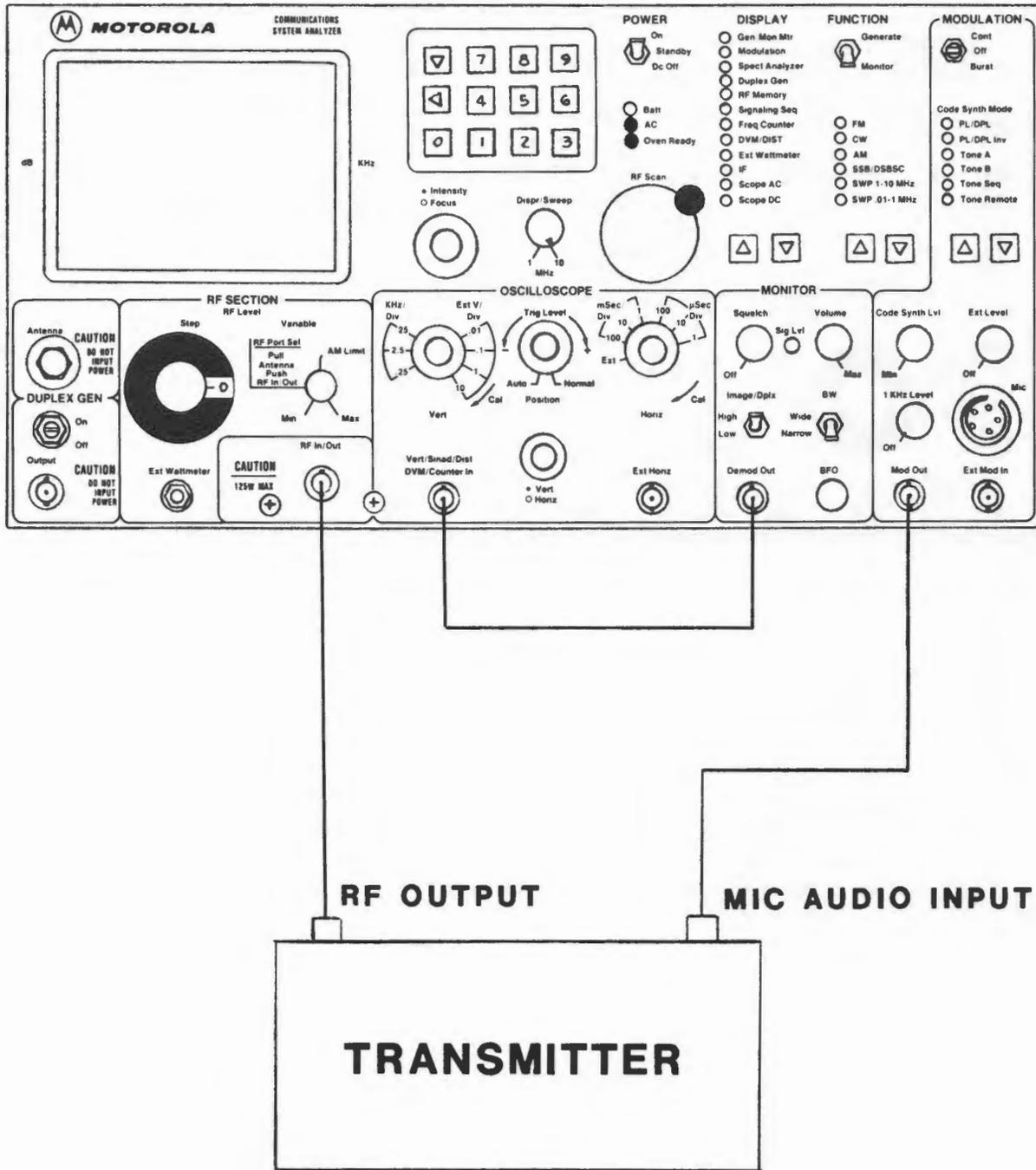
**FIGURE 4-9. AUDIO DISTORTION SETUP**
