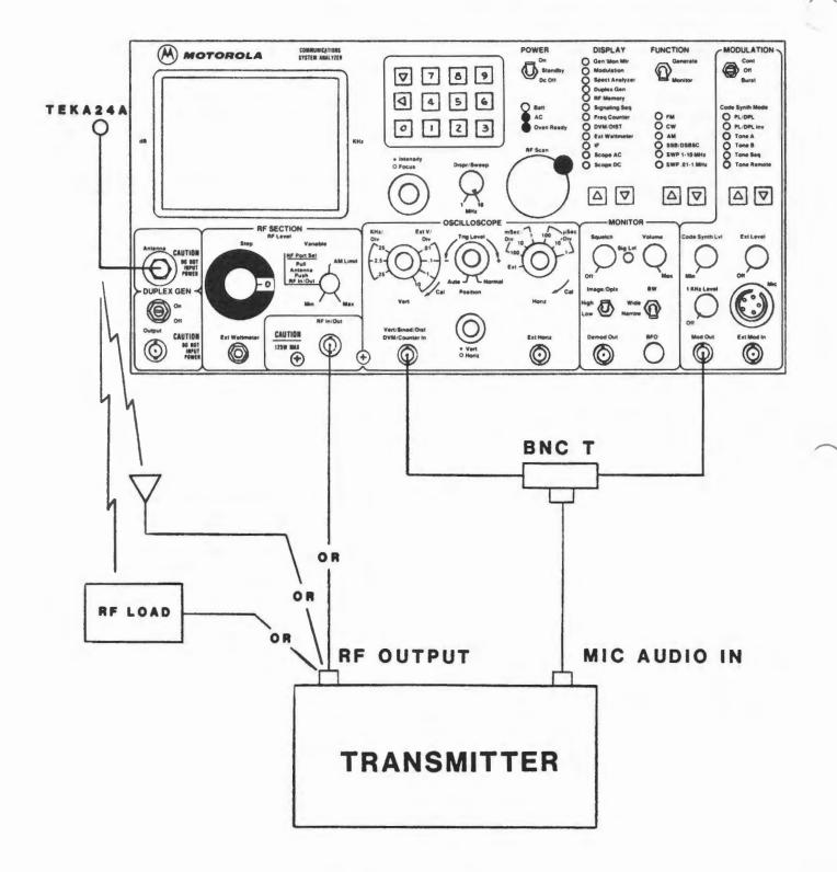
FIGURE 4-7. TRANSMITTER TESTS SETUP
